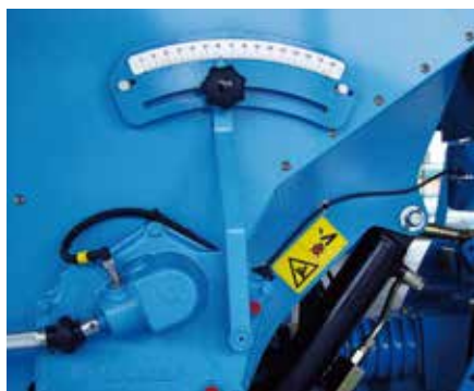
Бесступенчатый редуктор в масляной ванне
