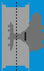
Специальные смещенные ободья Valley компенсируют увеличенную длину вала и позволяют разместить центр шины ближе к подшипнику редуктора. Это снижает внешнюю консольную нагрузку на подшипник, что продлевает срок его службы.
