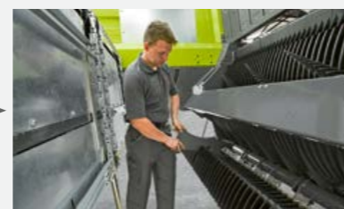
Перевернуть ножи и продолжить работу с заточенными ножами.
