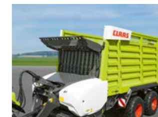
Загрузочная заслонка с гидравлическим поворотом вперед.
