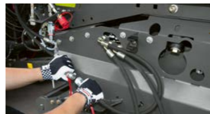
Отсоединение гидравлической муфты.
