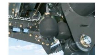
Гидроаккумуляторы для опционально поставляемого амортизатора дышла.
