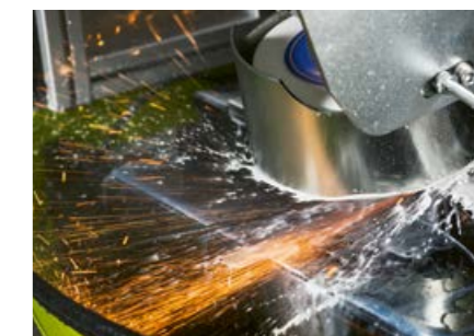
Благодаря правильному углу заточки ножи сохраняют оригинальный радиус и контур.
