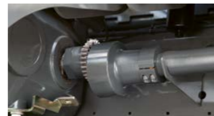
Отсоединение приводного вала.
