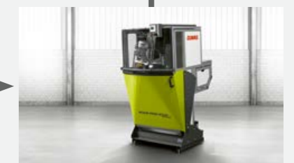
Затем заточить оба комплекта ножей с помощью AQUA NON STOP COMFORT по уникальной технологии мокрой шлифовки.
