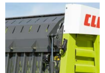
Угловой датчик на загрузочной заслонке.
