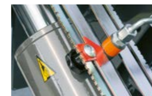
Стрелка-указатель для горизонтального положения складного дышла.
