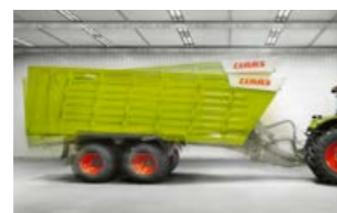
Гидравлическое складное дышло обеспечивает максимальный подъем и опускание всего прицепа.
