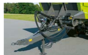
Складное дышло приводится в действие с помощью двух больших цилиндров двойного действия.
