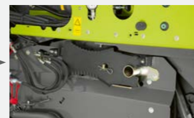
Установить второй комплект ножей из крепления.
