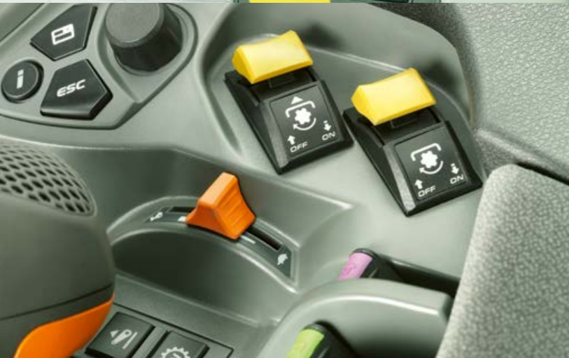
Внешнее управление передним и задним валами отбора мощности
