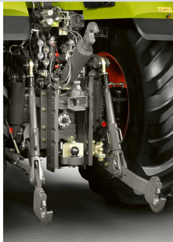
Внешние элементы управления для задней навески, ВОМ и секция гидрораспределителя на выбор
