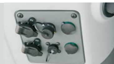
Разъемы питания (25 А, а также прикуриватель) и ISOBUS для дополнительных терминалов находятся под правой консолью.
