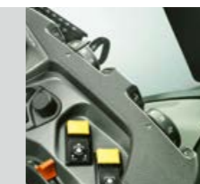
Установка рабочей глубины задней навески с помощью поворотного переключателя в подлокотнике
