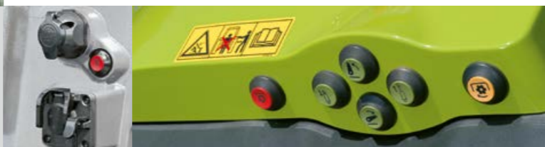
Внешнее управление передним и задним валами отбора мощности
