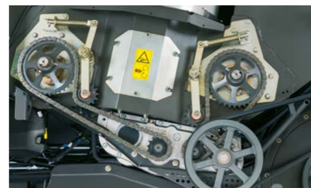
Редуктор системы выгрузки производительностью 180 л/с
