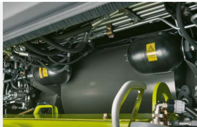
1 Амортизатор для равномерного распределения прессующего усилия на оба вальца 2 Гидравлическое устройство предварительного прессования для направления давления предварительного прессования на растительную массу
