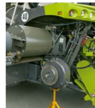
Быстрый демонтаж ускорителя
