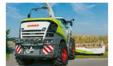
Опция: практичная консоль для защитного устройства приставки на время уборки
