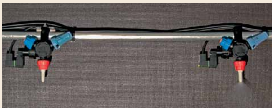
Вентиль форсунки с сенсором контроля потока
