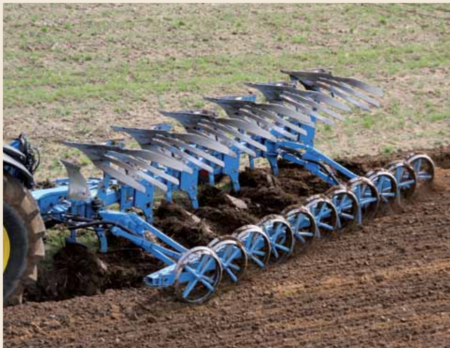
ФлексПак движется параллельно раме плуга
