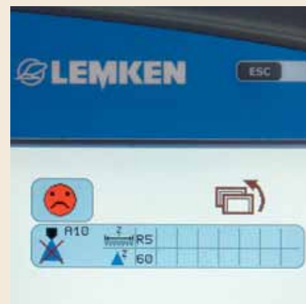
Уведомлена терминале о функциональных нарушениях на вентиле форсунки: Здесь ошибка A10 на форсунке №60 в 5м сегменте справа
