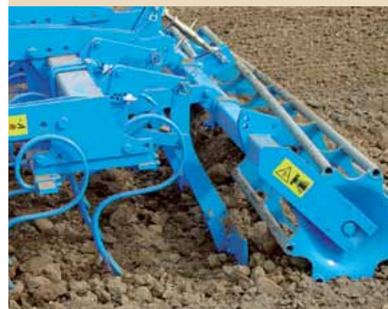
Многофункциональная балка, установленная агрессивно на срез.
