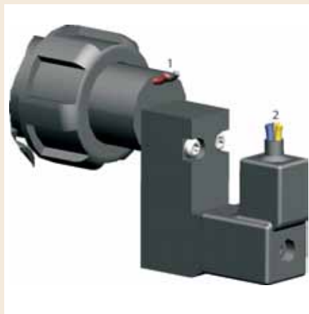
Вентиль форсунки (1) с сенсором контроля потока (2)
