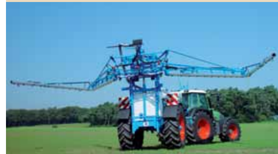
Устойчивые к скручиванию штанги, также и при складывании
