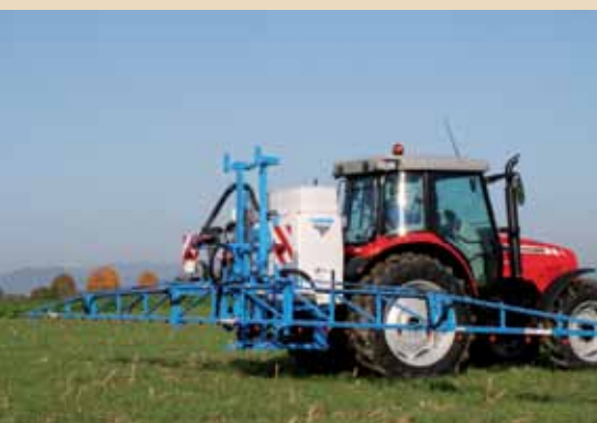
Компактная навеска на трактор, низкая разгрузка передней оси трактора
