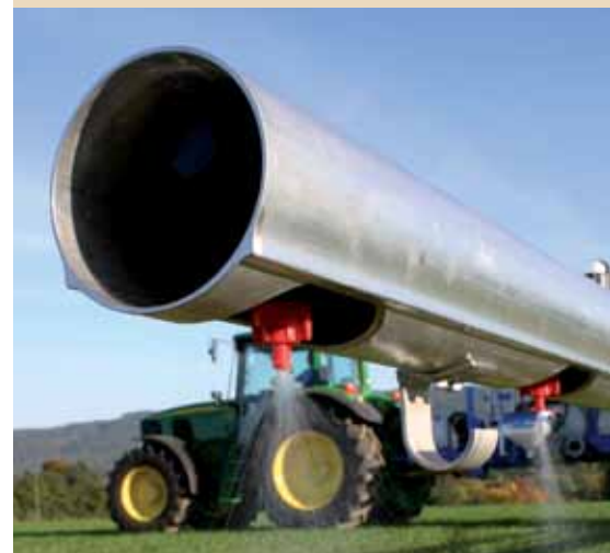
Проверенная и износоустойчивая конструкция: штанги из алюминиевой трубы
