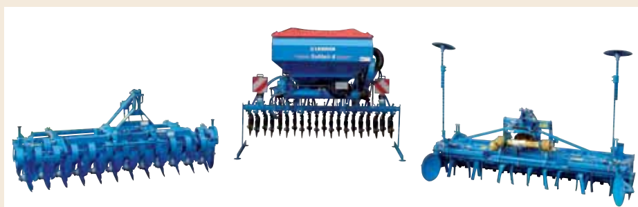
Идентичная точка соединения у короткой дисковой бороны Гелиодор и у ротационной бороны Циркон позволяют посменно использовать оба агрегата для обработки почвы
