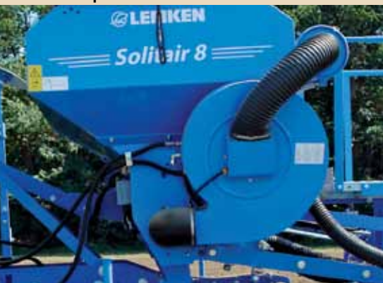
Вентилятор с гидравлическим приводом
