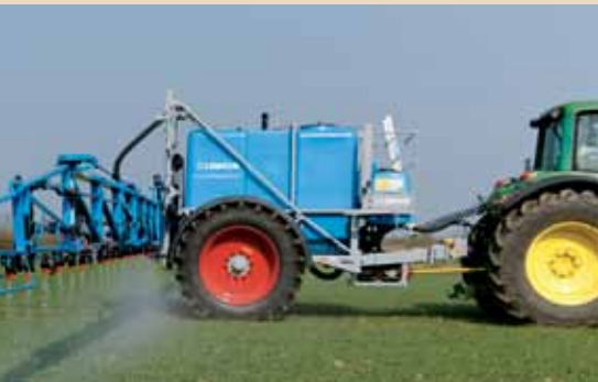
Короткое дышло для точного следования по колее
