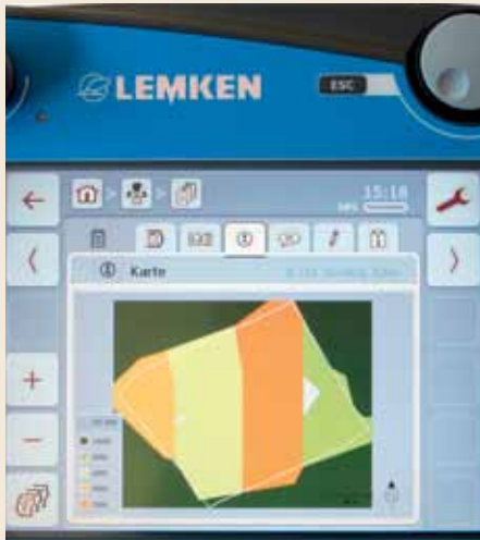
Танкконтроллер от ЛЕМКЕН связывает терминал с Farm менеджмент системой и делает возможной обработку почвы с учетом особенностей отдельных частей поля
