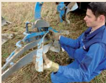
Быстроизнашивающиеся детали корпусов ЛЕМКЕН DuraMaxx заменяются быстро и без инструментов.
