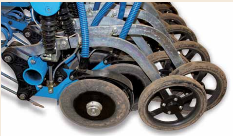
Двойной лемех OptiDisc с сенсором (1) для регистрации давления на ролик ведения глубины
