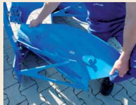
Перья и отвалы корпусов ЛЕМКЕН DuraMaxx закрепляются при помощи всего лишь двух болтов
