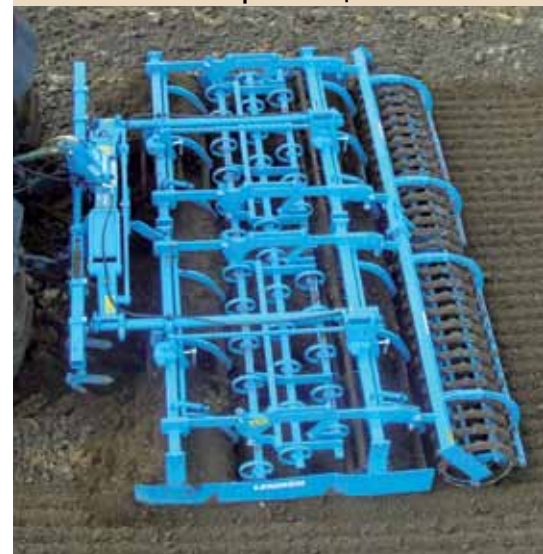
Порядок расположения рабочих органов
