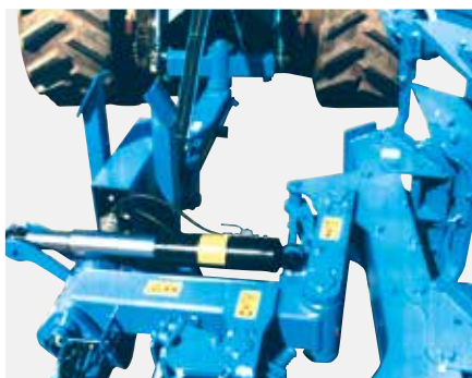
Установка положения плуга «вне борозды»
