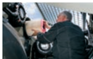
Замена воздушного фильтра без использования инструментов
