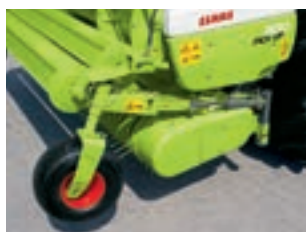
Гидравлически откидываемые копирующие колеса
