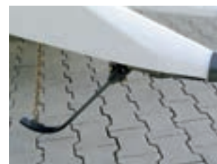
Скобы-копиры определяют положение жатки для AUTO CONTOUR и CONTOUR.
