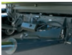
Цилиндры приставки двойного действия точно регулируют давление на почву.
