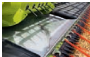
Направляющий элемент с направляющей траектории
