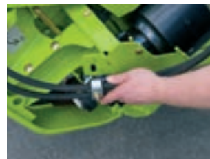
Простое подвешивание гидравлических шлангов для привода рапсовых ножей
