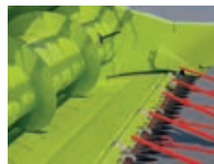
Стол жатки выдвинут – уборка зерновых (+100 мм)
