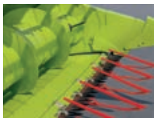
Стол жатки задвинут – уборка зерновых (-100 мм)
