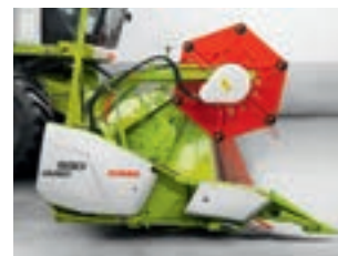
Стол жатки выдвинут – уборка зерновых (+600 мм)
