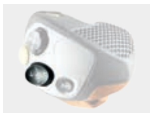
Активация CONTOUR, AUTO CONTOUR и MULTI CONTOUR прямо на рычаге управления
