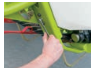
Простая регулировка стеблелителя по высоте с помощью складного ключа
