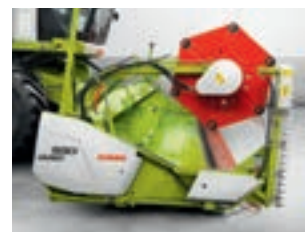
Стол жатки выдвинут – с рапсовым ножом (+600 мм)
