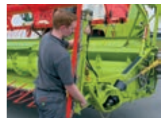
Установка рапсовых ножей с помощью быстродействующего затвора
