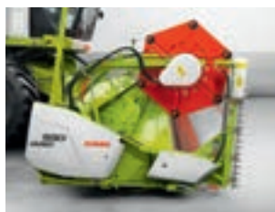
Стол жатки задвинут – с рапсовым ножом (+450 мм)
