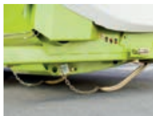
Скобы-копиры определяют положение жатки для AUTO CONTOUR и CONTOUR.
