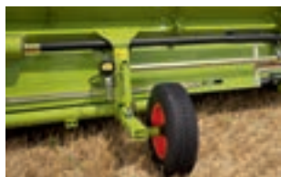
Стабилизирующее колесо для оптимального ведения приставки
