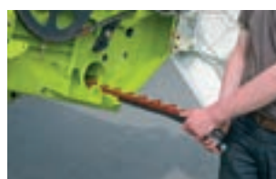
Запасной нож встроен в жатку снизу
