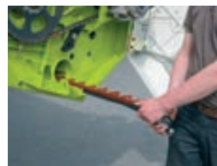
Сменный ножевой брус встроен в жатку снизу
