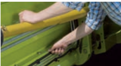
Регулируемые снаружи скребки (С 490, С 430, С 370)
