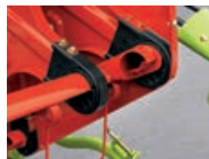
Пластмассовые держатели и опоры граблей оптимизированной формы для уменьшения захвата стеблей
