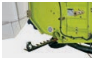
Запасной нож встроен в жатку снизу
