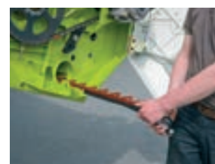
Запасной нож встроен в жатку снизу
