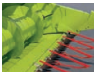
Стол жатки задвинут – уборка зерновых (-100 мм)
