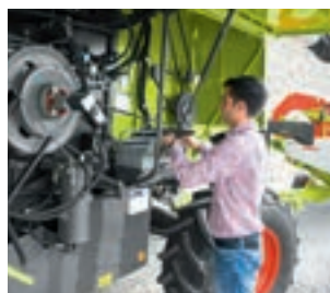
Большие боковые капоты для удобного доступа
