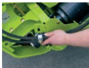
Простое подвешивание гидравлических шлангов для привода рапсовых ножей
