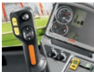
Кнопка регулировки высоты на многофункциональном джойстике позволяет с легкостью включить AUTO CONTOUR.
