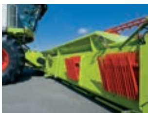
Запасные колосоподъемники сзади жатки
