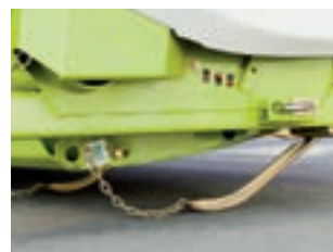
Скобы-копиры определяют положение жатки.
