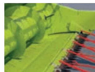
Стол жатки выдвинут – уборка зерновых (+100 мм)
