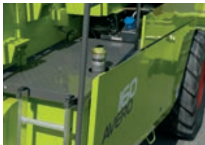
AVERO 240: объем топливного бака 400 л AVERO 160: объем топливного бака 400 л/320 л
