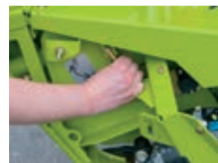
Блокировка стеблелителей и рапсовых ножей без инструмента с помощью быстродействующего затвора
