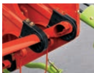
Пластмассовые держатели и опоры граблин оптимизированной формы для уменьшения захвата стеблей
