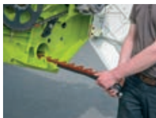
Запасной нож встроен в жатку снизу
