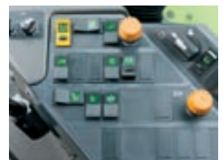
Автоматическое управление мотовилом активируется при помощи тумблера на боковой консоли.
