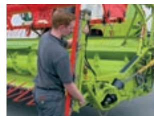
Установка рапсовых ножей с помощью быстродействующего затвора
