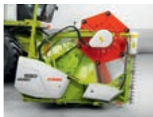
Стол жатки задвинут – с рапсовым ножом (+450 мм)
