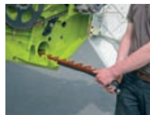
Запасной нож встроены в жатку снизу
