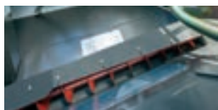
Гладкие внутренние поверхности зернового бункера
