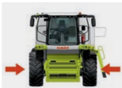
Сниженная транспортная ширина при увеличенной опорной поверхности
