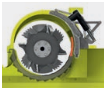
Регулировка направляющего щитка ротора CEBIS
