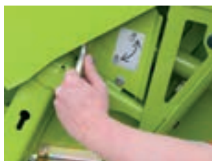
Блокировка стеблелителей без инструмента с помощью быстросействующего затвора
