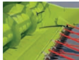
Стол жатки выдвинут – уборка зерновых (+100 мм)
