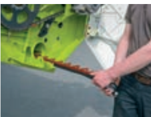
Запасной нож встроен в жатку снизу
