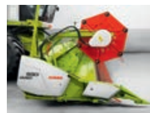
Стол жатки выдвинут – уборка зерновых (+600 мм)
