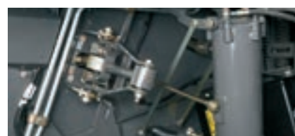
Гидравлический модуль управления очисткой 3D
