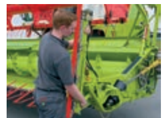
Установка рапсовых ножей с помощью быстродействующего затвора
