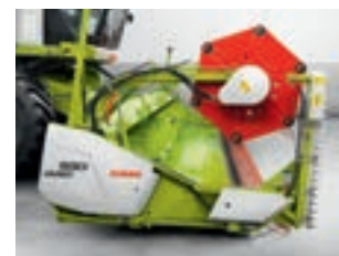
Стол жатки выдвинут – с рапсовым ножом (+600 мм)
