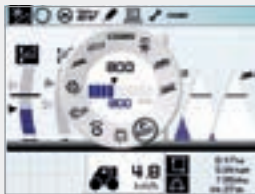
Регулировка частоты вращения ротора в CEBIS
