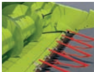
Стол жатки задвинут – уборка зерновых (-100 мм)
