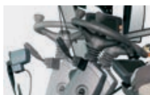
Рулевая колонка регулируется в 3 направлениях.
