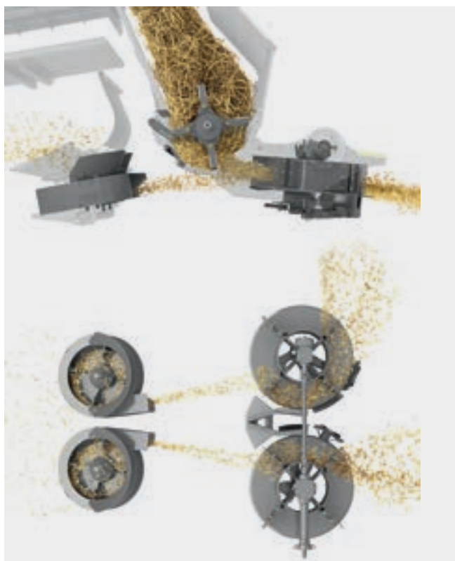
Радиальный распределитель в режиме измельчения.
