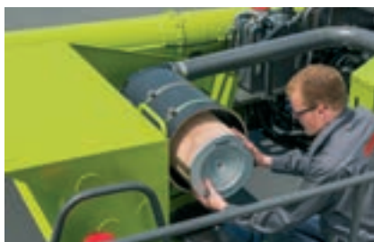
Воздушный фильтр удобно снимается для очистки.
