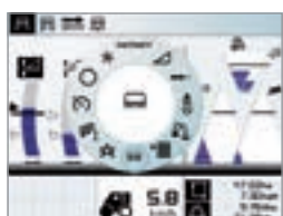
Ручная настройка направления и ширины разбрасывания в CEBIS
