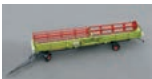
Двусная транспортная тележка с управляемой задней осью
