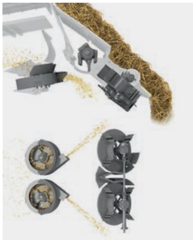
Радиальный распределитель при укладке в валок.
