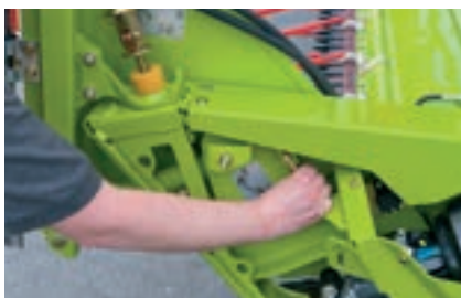
Блокировка стеблеотделителей и рапсовых ножей без инструмента
