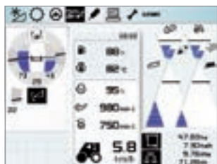
Индикация положения регулировки жатки в CEVIS
