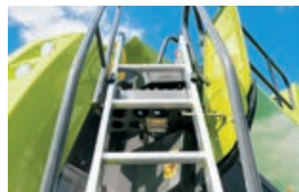
Сервисное освещение на лестнице
