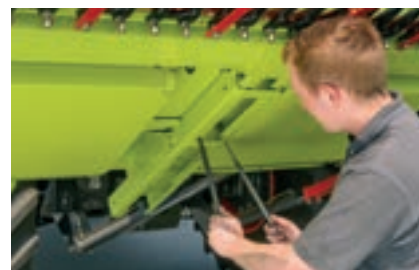
Регулировка длины стола на CERIO 930/770
